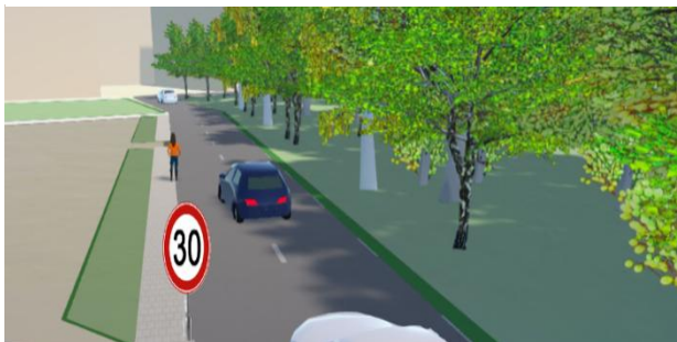
Figuur 35. Plaatsing trottoir + A01-30 bord
