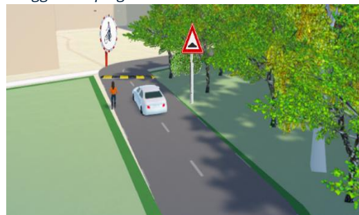
Figuur 34. Plaatsing drempel, RVV J38 bord, veiligheidsspiegel
