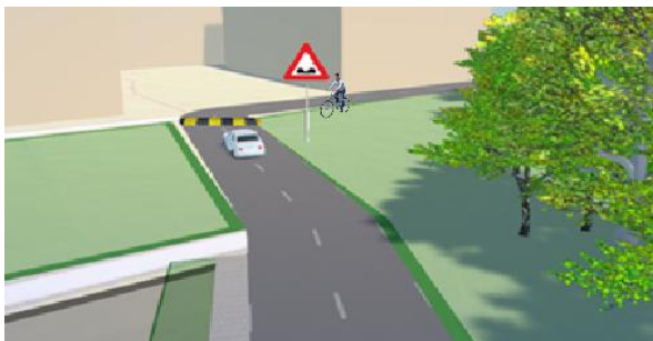
Figuur 39. Overzichtelijke bocht door verwijdering van begroeiing, plaatsing drempel en bord RVV J38
