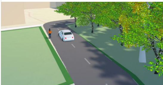
Figuur 79. Dode hoek Tussenbusstraat. Fietser van rechts is niet te zien
